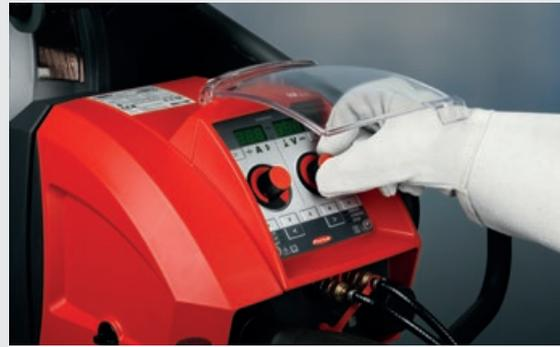
/ Einfaches und bedienerfreundliches User-Interface für schnelle Bedienung ohne aufwändige Einschulung. Die robuste Schutzabdeckung ist optional erhältlich.
