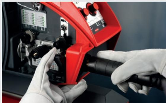
/ Der System Connector ist das Rückenmark der TransSteel. Alle Medien laufen durch diesen zentralen Anschluss. Ein Hebelverschluss verriegelt das Schlauchpaket schnell, fehlerfrei und ohne Werkzeug.
