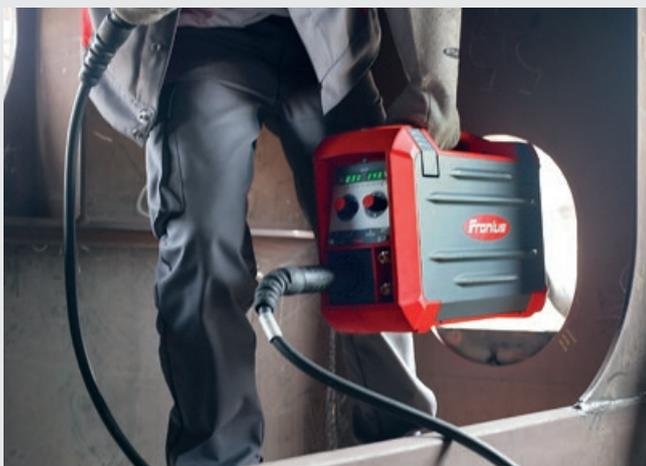
/ Mit weniger als 10 kg und geringsten Störkonturen passt der VR 5000 Case durch jedes im Schiffbau übliche Mannloch bis zu 350 mm.
